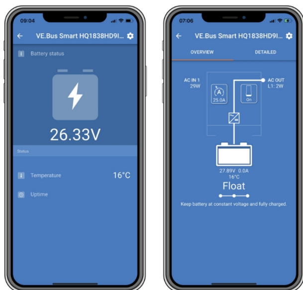
Obrazovky VictronConnect bez a s připojeným měničem/nabíječkou.
