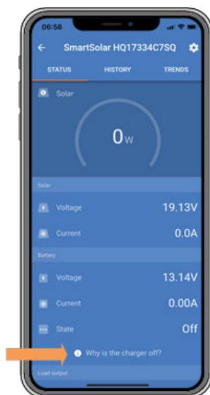
VictronConnect – odkaz na „proč je nabíječka vypnutá“
