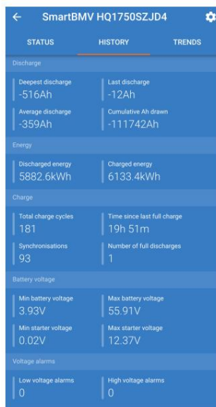
Aplikace VictronConnect zobrazují historii monitoru baterie BMV
